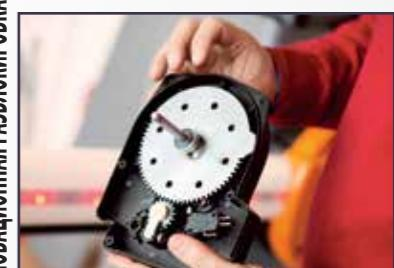
Благодаря оригинальной конструкции механизма разблокировки передачи шлагбаума в ручной режим может быть произведен без усилий в любой точке.
