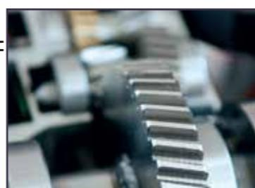
Все шестерни редуктора шлагбаума производятся только в компании «Roger Technology» и изготавливаются из стали и бронзы. В передаче использованы надежные низкошумящие зубчатые колеса с наклоном зуба 15°.
