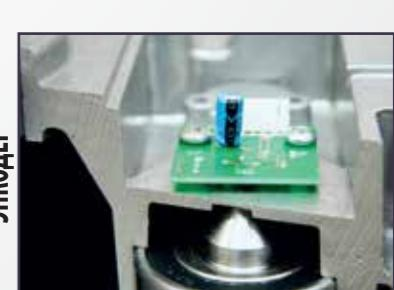
Усовершенствованный энкодер, установленный на выходном валу редуктора, позволяет в случае отключения питания или перевода в ручной режим возобновить эксплуатацию шлагбаума не повторяя процедуру обучения системы.
