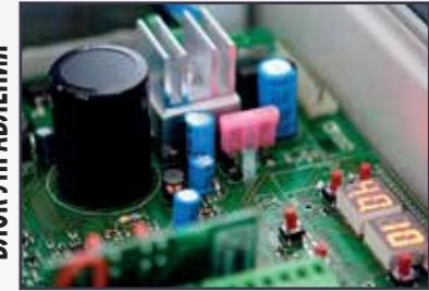
Точная настройка режимов шлагбаума производится при помощи цифрового блока управления. Для удобства настройки блок управления расположен в верхней части шлагбаума.
